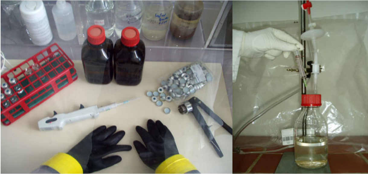
Abbildung 6-3: Angewandte Probenahme-Techniken unter anaeroben Bedingungen (links: Arbeitsplatz Anaerob-Box; rechts: Zugabe von Formiergas über einen Gasbeutel)
