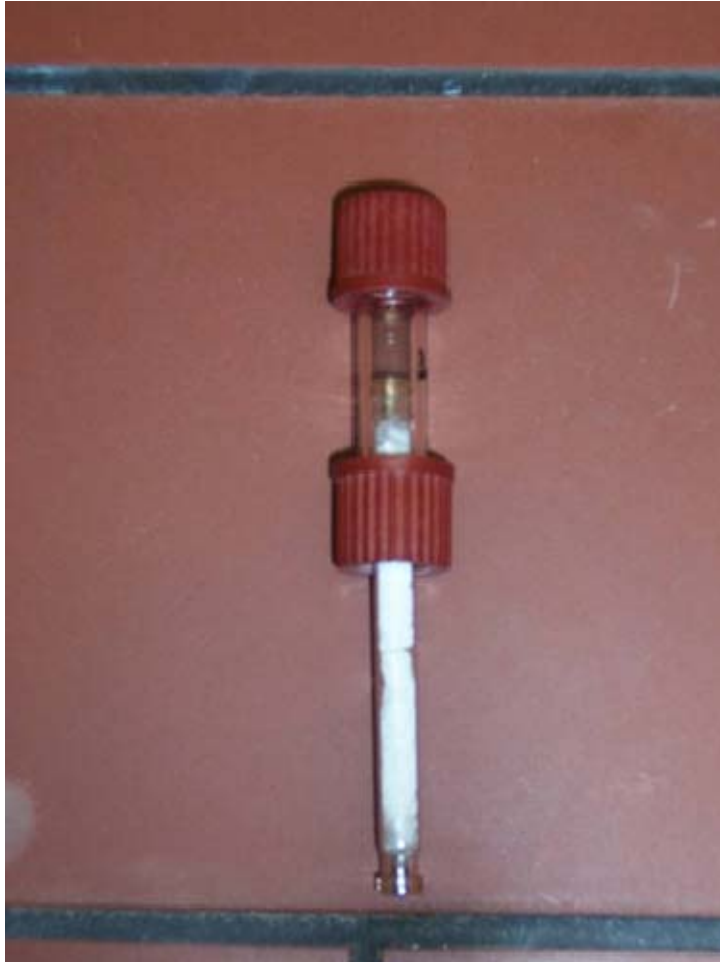
Abbildung 7: Doppelgewinderohr mit Sorptionsröhrchen
