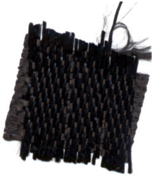
Bild 3-1: ACF-Gewebe CS 1501 (Gewebestück mit 2 cm Kantenlänge)
