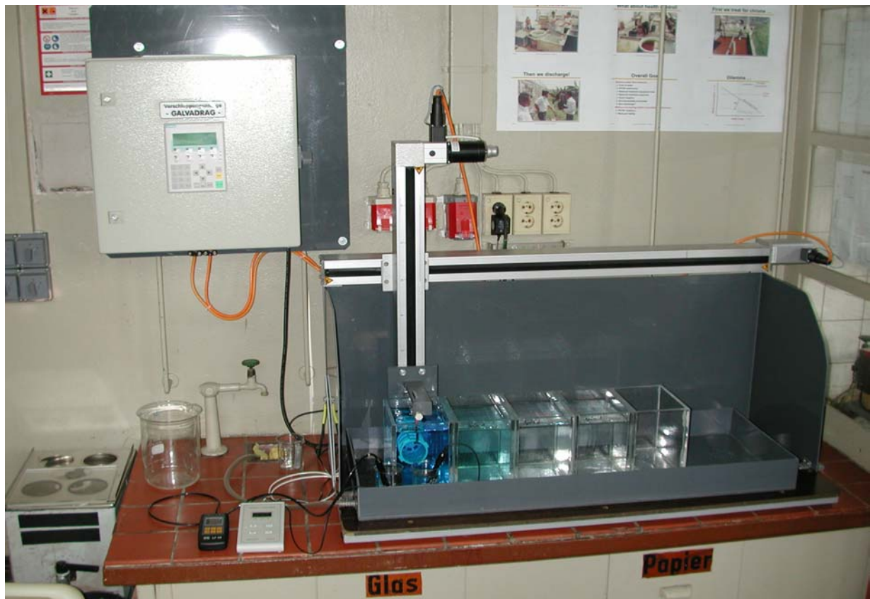
Abb. 2.12: Verschleppungsanlage mit Behälter und Steuerschrank
