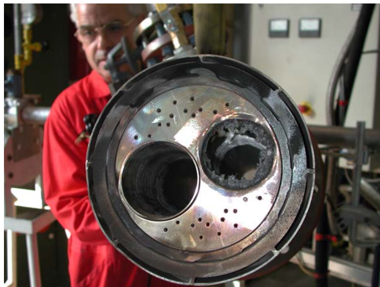
Bild 3: Gasbrenner zur Textilstaubmitverbrennung (Variante 2 mit gas-elektrischen Zündbrenner und exzentrischer Staubaufgabe) (Zündbrenner und Staubaufgabe ausgebaut)
