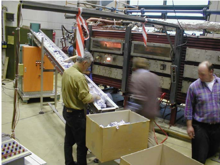
Bild 7: Staubaufgabe während der Versuche
