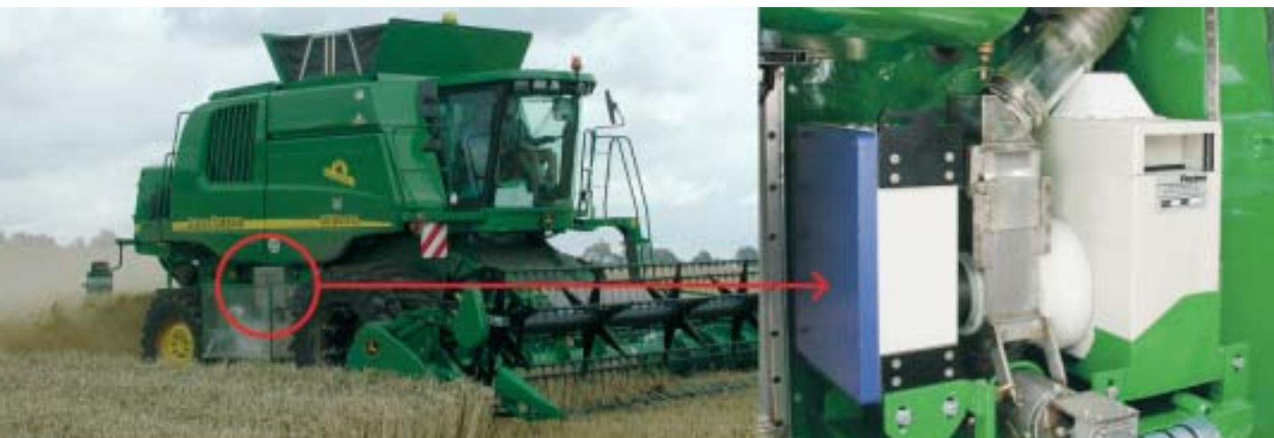
Serienmähdrescher mit Messplattform zur Echtzeitbestimmung von Inhaltsstoffen
